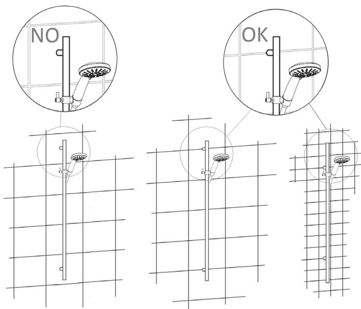
Широкий диапазон регулировки межосевого расстояния означает, что крепления всегда можно установить внутри цементного раствора без сверления облицовки.
