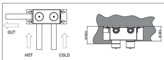
Вставьте скрытый узел с защитным кожухом, крепежными пластинами и контрольными ручками, установленными в паз.
