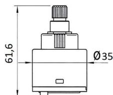
• Картридж для переключателя на 2 выхода с закрытием  $\varnothing 35$
