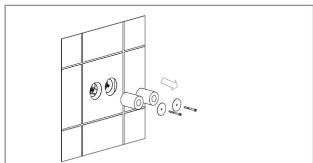
Когда облицовка будет завершена, удалите фиксирующие пластины и ручку проверки системы.
