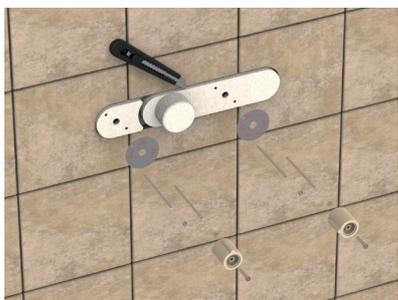
Когда покрытие будет завершено, снимите фиксирующие пластины и ручку проверки системы, приложив ее вплотную к защитной пластине.
