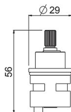
• Картридж для переключателя на 2 выхода без закрытия  $\varnothing 29$
