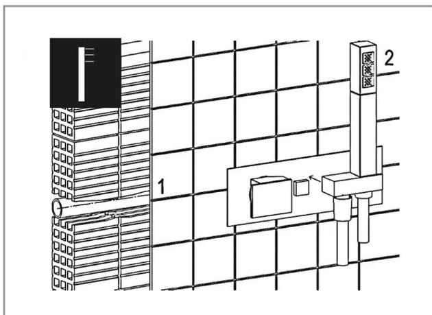
В случае, если кнопка всегда возвращается в исходное положение, предотвращая отклонение ручного душа (проблема из-за давления в системе ниже одного бара), система ручного перекрытия позволяет вмешаться, заблокировав ее вручную.
