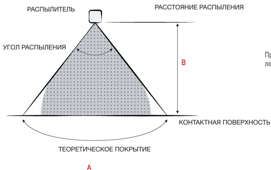
При давлении 3 бар угол распыления имеет диапазон 70°.
