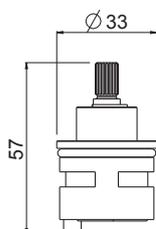
• Картридж для переключателя на 3 выхода без закрытия  $\varnothing 33$
