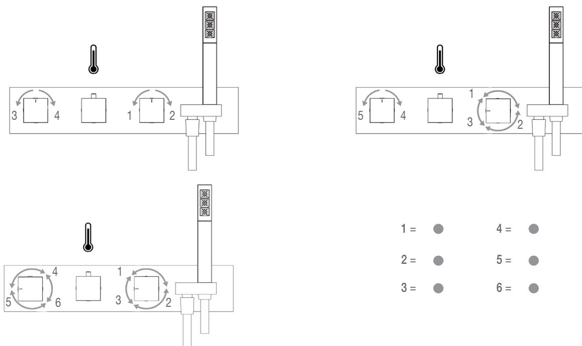
**ОДНОРЫЧАЖНОЕ УПРАВЛЕНИЕ 2 ВЫХОДА ( 2 выхода не одновременно )**
