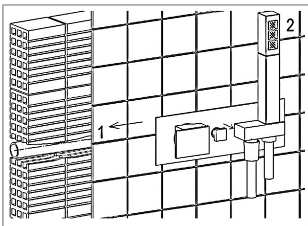
В исходном положении (с вытянутым переключателем) вода отводится к выходу 1 (основная сеть).
