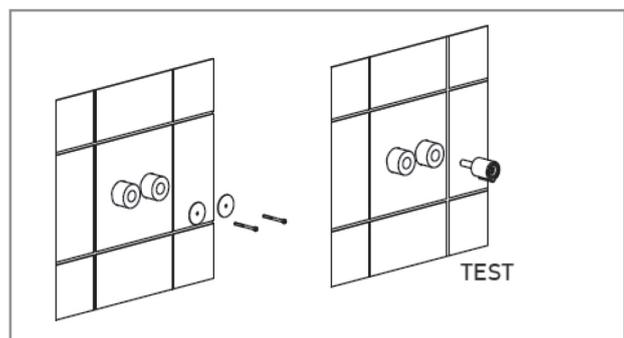
Проверьте глубину погружения встроенного корпуса, как указано на защитной крышке, в завершение следует выполнить отделку штукатуркой и облицовкой.
