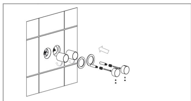
Обрежьте пенопластовую защиту и сделайте отверстия для крепления ручек.
